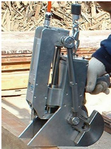
写真3 改良型釘抜き装置
