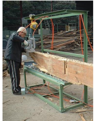
写真4 釘抜き装置による作業
