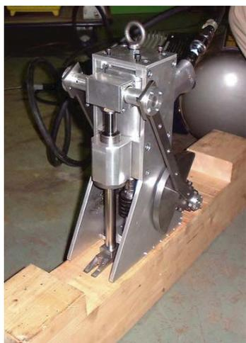
写真2 釘抜き装置
