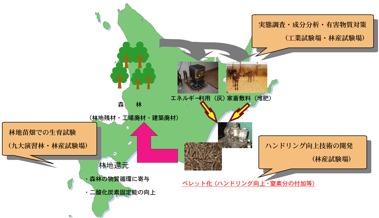
図2 「木質系バイオマス燃焼灰の有効利用に関する研究」が目標とする林地還元システム
