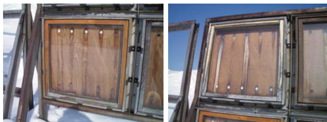
写真6 木製サッシの暴露試験 (造膜タイプ南面 15年目) 左：茶色に着色 右：透明
