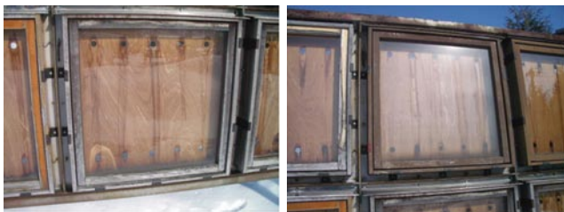
写真4 木製サッシの暴露試験 (半造膜タイプ南面 15年目) 左：取付後再塗装無し 右：再塗装有り
