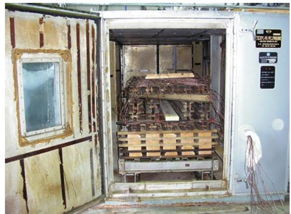
写真5 集成材用ラミナの乾燥実験
