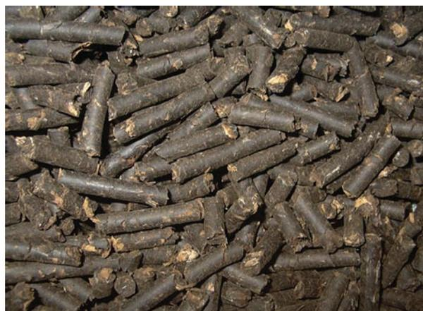
写真4 燃焼灰を利用したペレット
