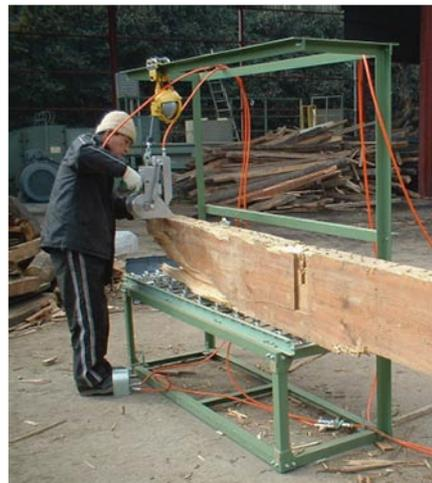
写真2 釘抜き作業
