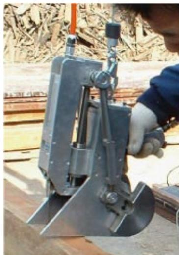
写真1 開発した釘抜き装置
