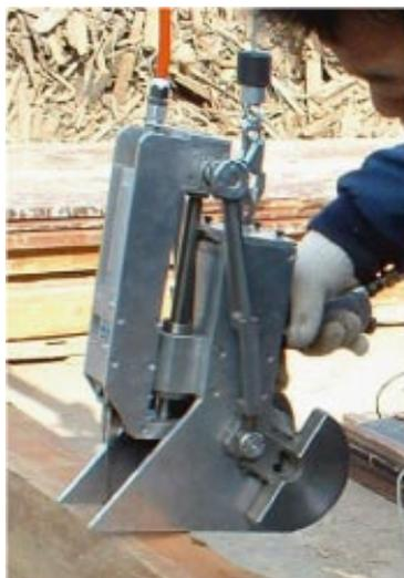
写真1 開発した釘抜き装置
