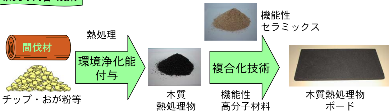
図1 熱処理複合化技術による成型物の製造
