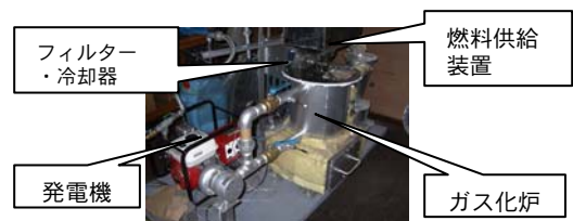
写真2 ダウンドラフト型ガス化炉
