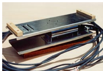
写真1 ロードセルを用いた含水率センサー
