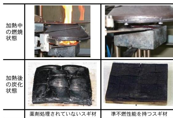
写真 薬剤処理木材の燃焼抑制効果
