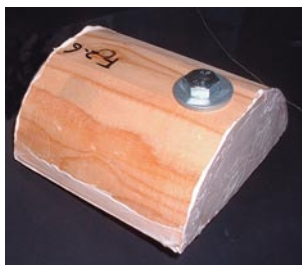
写真 2 防雪柵の接合部を想定した試験体
