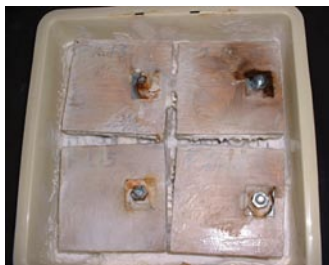
写真 3 強制腐朽処理の様子
