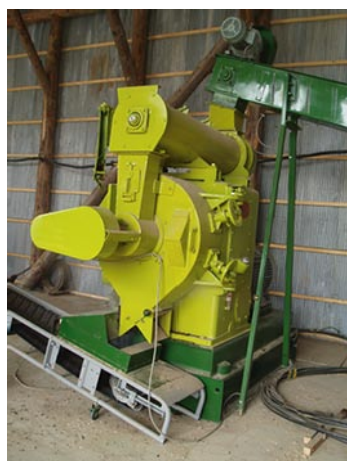
写真5 リングダイ型ペレット製造装置（厚沢部町）
