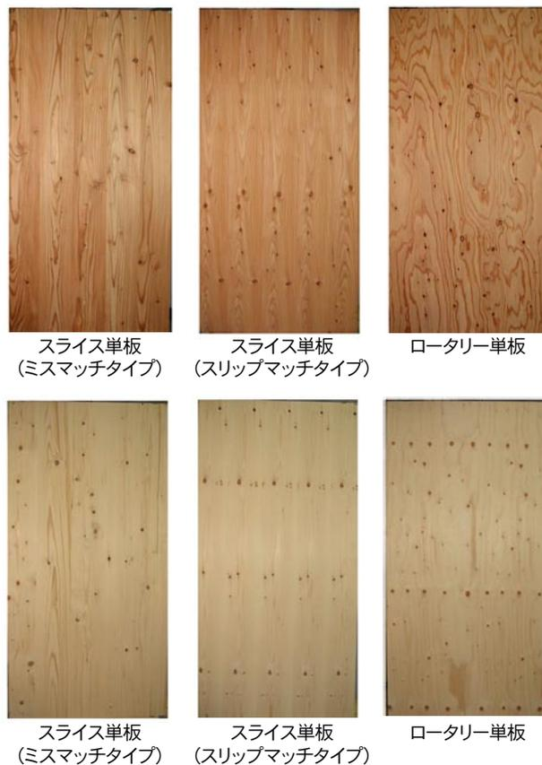
写真2 試作した内装用針葉樹合板
