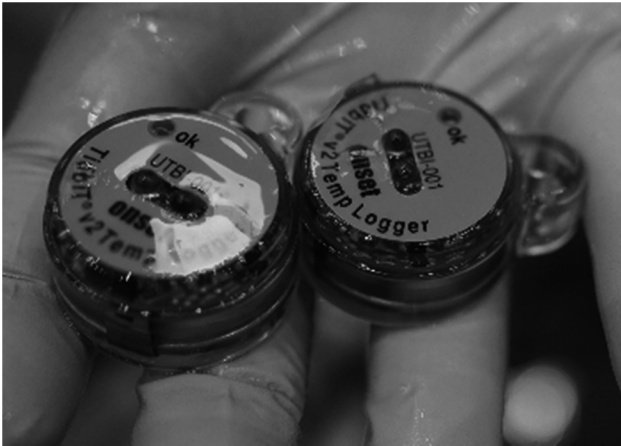
写真1 EAT算出に使用した温度ロガー
