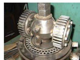
写真3 ペレット製造装置
