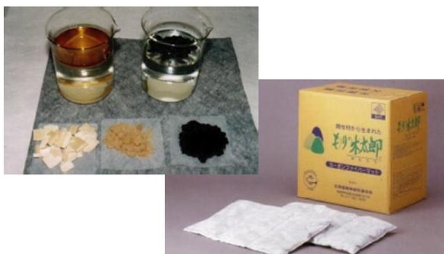
写真1 トドマツファイバーの油吸着材
