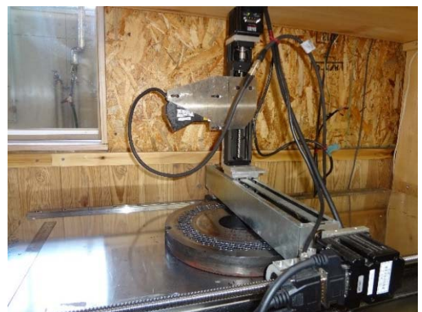
第2図 レーザー変位計によるダイスの摩耗測定の様子
