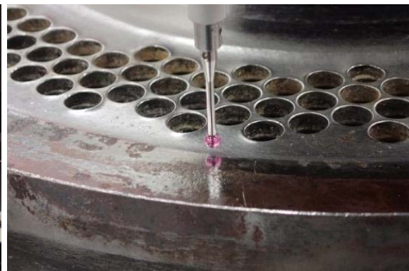
第5図 三次元測定器によるダイスの摩耗測定の様子
