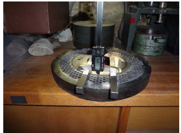
第4図 デプスマーターによるダイスの摩耗測定の様子
