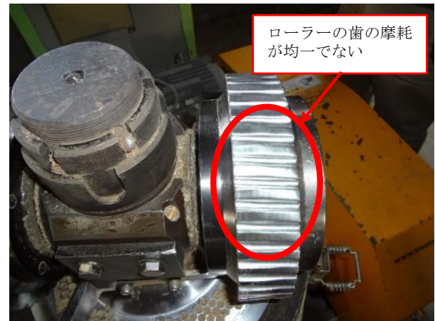
第12図 ローラーの摩耗の様子
