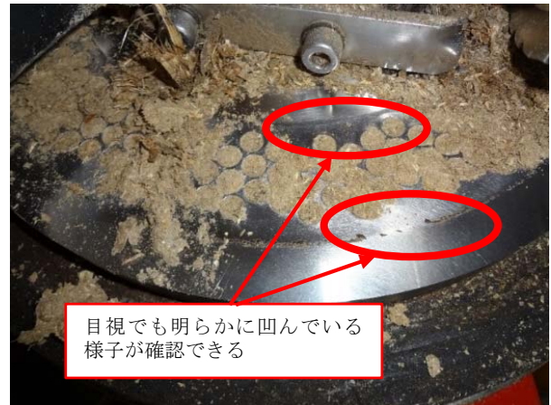
第11図 ダイスの摩耗の様子
