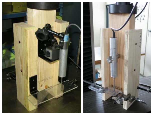
第1図 釘接合部の強度試験 （左図：製材と製材、右図：製材と面材）
