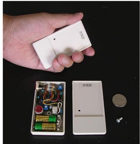
写真3 方位指示装置の概観
