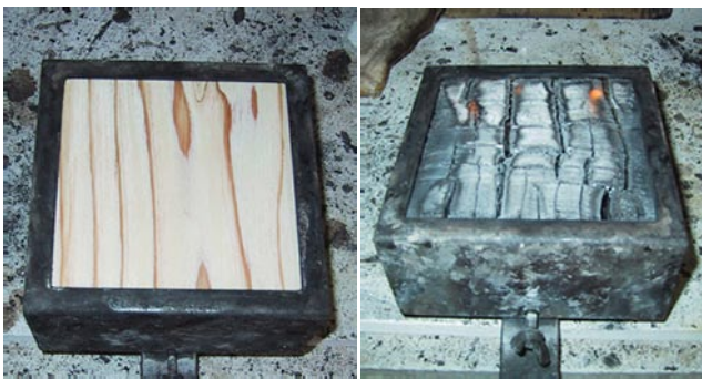
写真2 試験体(左：試験前, 右：試験終了後)
