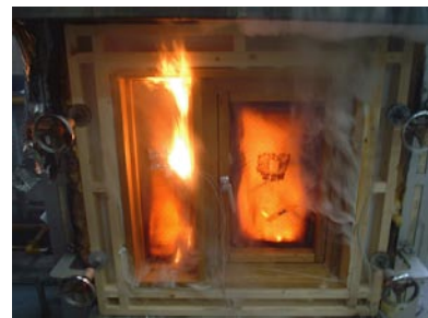
写真4 木製サッシの防火試験
