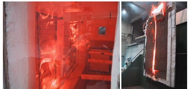
写真3 外壁の防耐火試験(左：炉内, 右：試験終了後)
