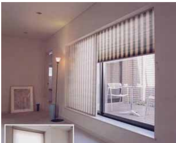
写真1 ハニカムサーモスクリーンの実証例
