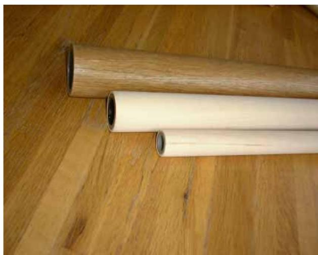
写真5 木材・金属複合パイプの完成例
