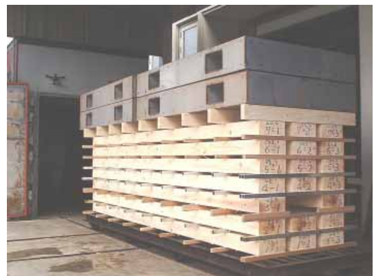
写真2 蒸気式木材乾燥装置と積み重ねた平角材
