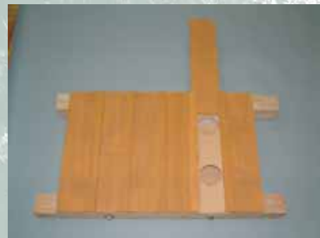
・外装材を取付け、ボルト施工用の開口を隠す
