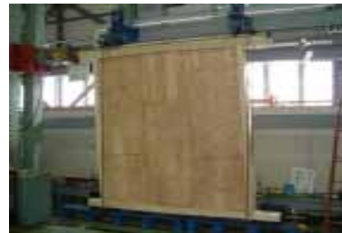
写真2 床組のせん断試験
