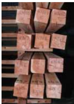
写真1 未乾燥材のねじれ
