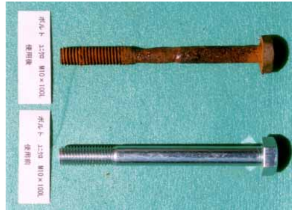
錆びて細くなったボルト(上のボルト) 直径10mmが7mmになった
