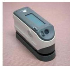
据置型 分光測色計 ハンディ型 分光測色計
