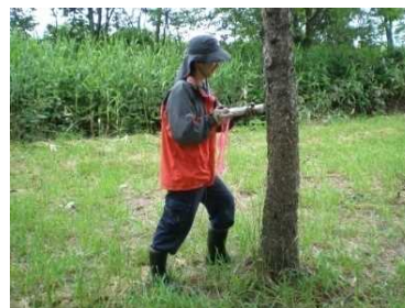
写真-1 ピロディン陥入量の測定方法
