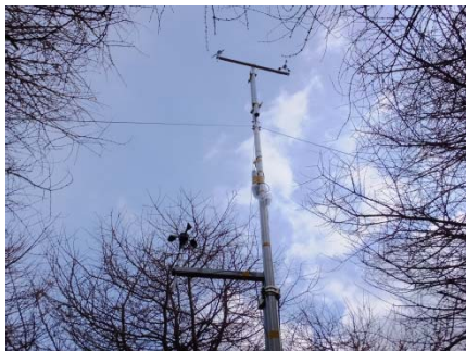
千鳥抜き間伐試験地への風向風速計の設置の様子(浜中町)。2014年11月から観測中。
