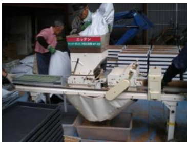
図-5 挿し木用ペーパーポット土詰め工程の機械化
