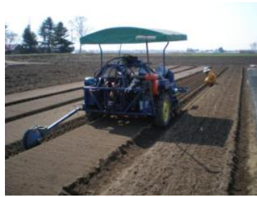
図-6 挿し木苗床替え工程の機械化(左)と小さい挿し木苗を掴むために改良したブレード(右)
