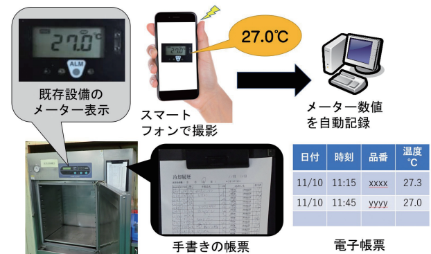
図23 メーター読み取りサービスによる自動記録
