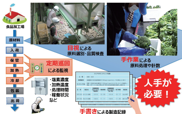
図1 食品加工工場の工程例
