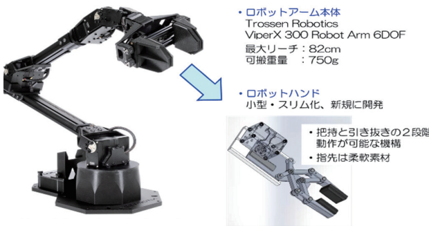
図4 ロボットアームの構成
