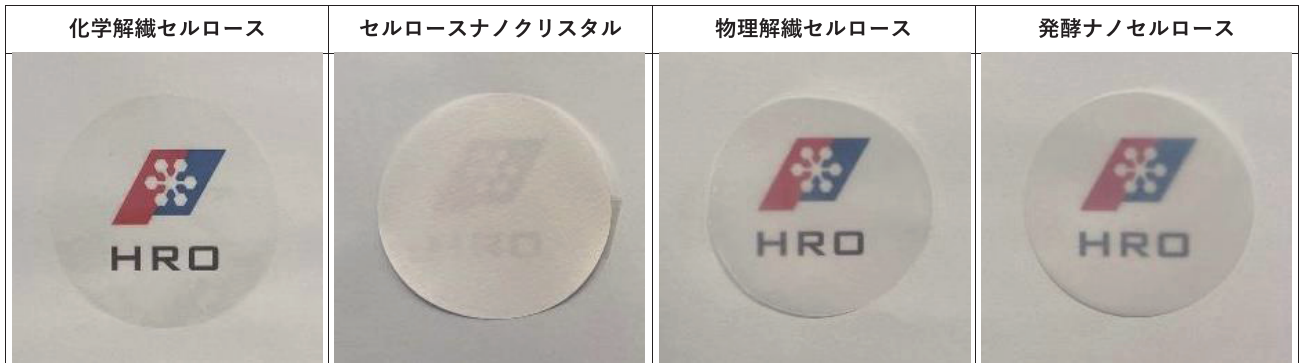
図5 バイオマスフィルム (Φ 65mm) の外観画像 セルロースナノクリスタルは割れ防止のためろ紙上に製膜している
