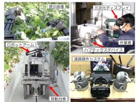
写真3 イチゴハウス栽培管理作業向け遠隔操作ロボット
