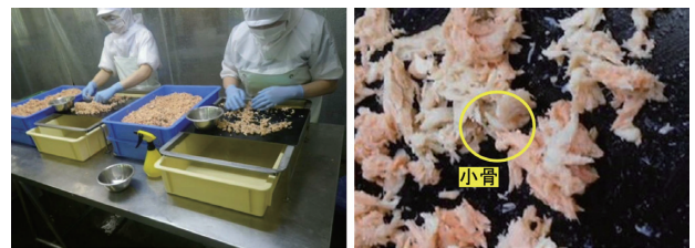
図 13 左：鮭フレークの検査工程 右：鮭の身と骨(異物)
