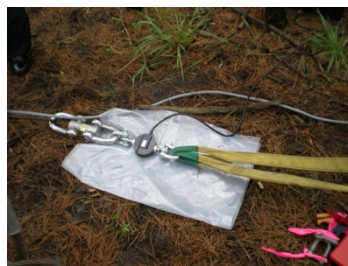
写真1. 引き倒し試験用の立木 写真2. 荷重測定用のセンサー
