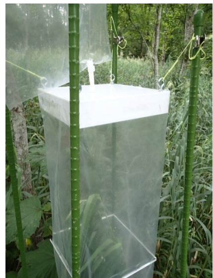
試作した植生フラックス用チャンバー
