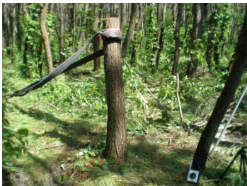
写真1. 引き倒し試験用の立木 写真2. 荷重測定用のセンサー
