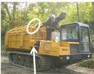
→の部分が横にスライドし ○の部分の羽が開いて展開できる
