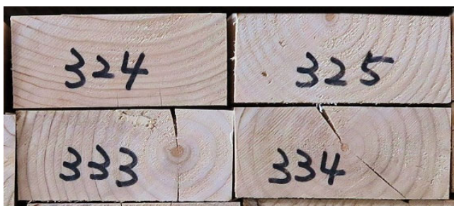
写真1 トドマツ羽柄材の木口面 （上段：心去り・心掛かり、下段：心持ち）
