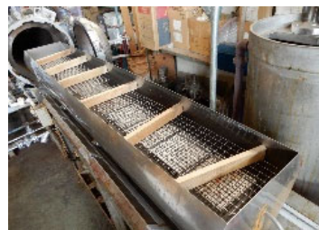
写真3 減圧加圧による強制吸水
