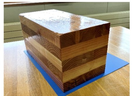
写真1 ポリウレアで被覆されたカラマツCLT試験体
