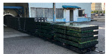
写真5 ナフテン酸銅（油剤）の加圧注入処理を行ったCLT（スギ）
