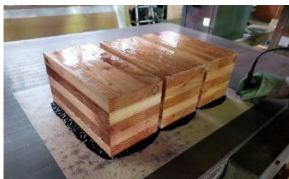
写真2 アスファルト敷設を想定した試験体の加熱 加熱条件：160℃（10分）→120℃（10分）→100℃（23分）
