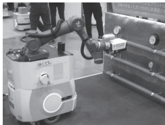
図 3 動作風景（展示会でのメータ検査デモンストレーション）
