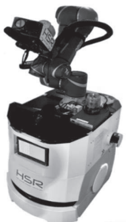
図 1 構築した自動走行ロボットシステム
