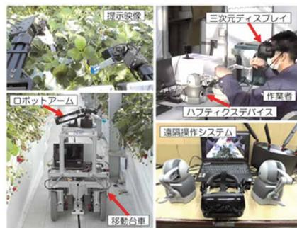
写真3 イチゴハウス栽培管理作業向け遠隔操作ロボット
