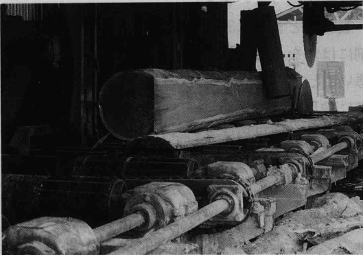
写真2 丸鋸による製材工場(パニモ)
