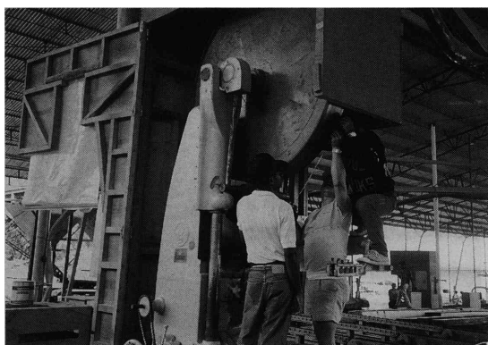
写真5 鋸車の精度の測定(サグ)
