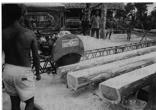
写真7 “Wokabaut Somil” による製材風景
