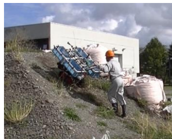
図-4 改良した小型運搬機 コンテナ容器を4つ積み、30度の傾斜まで登坂できる。
