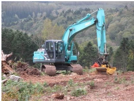
図-2 クラッシュ地拵え 0.7クラスのベースマシンに装着 (森林総合研究所と共同調査)
