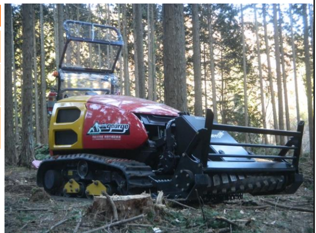
図-2 新たに開発・改良された小型マルチャー ( (株)筑水キャニコム社製 )
