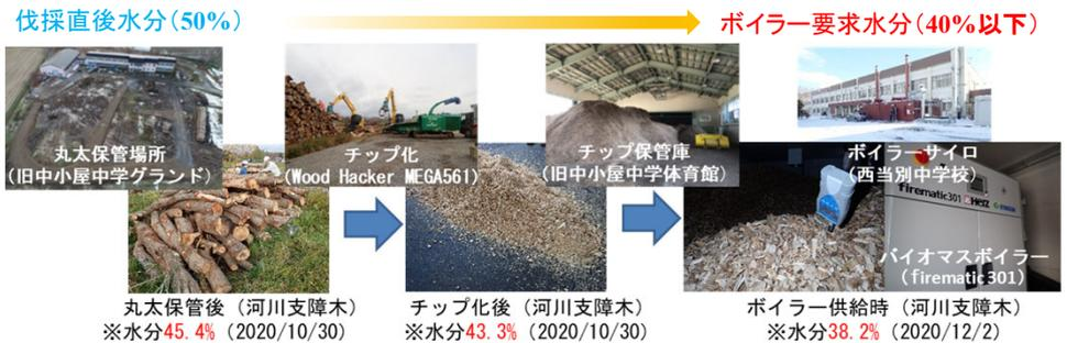
図1 天然乾燥と移動式チップパーによる木質チップ燃料の供給(当別町)
