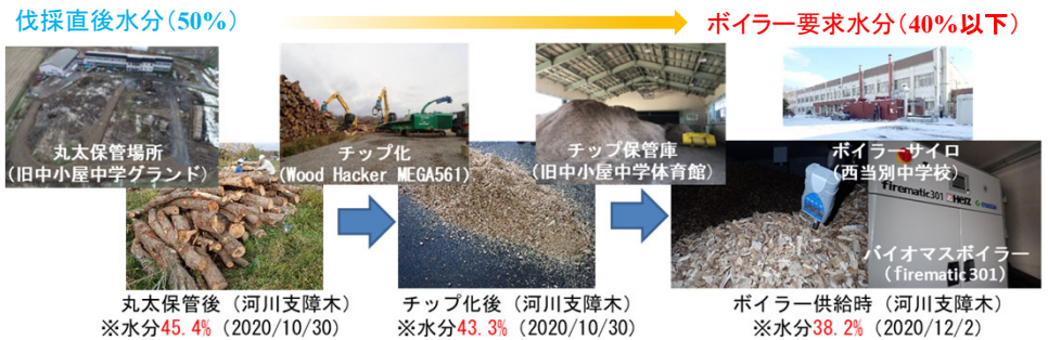
図1 天然乾燥と移動式チップパーによる木質チップ燃料の供給(当別町)
