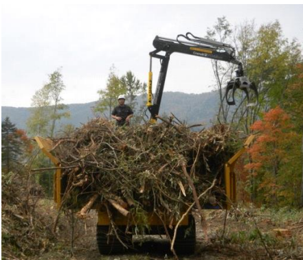
図-1 バイオマス収集対応型フォワーダ (MST800VDL、荷台が横に開閉し枝条を圧縮する)
