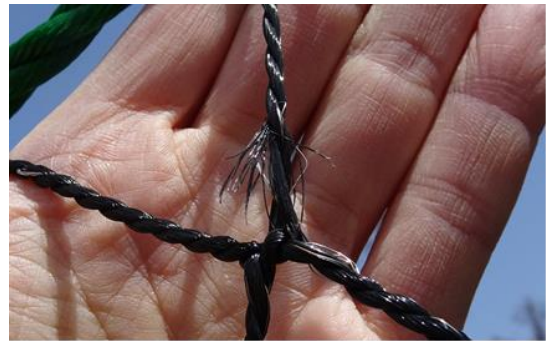
写真-2 完全には破網しなかったが、積雪による引っ張りによりステンレスワイヤーが切れた従来ネット
