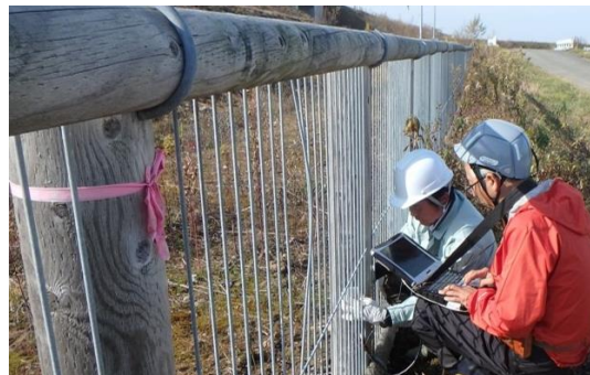
写真-2 樹木内部欠陥非破壊診断装置を用いた診断の様子
