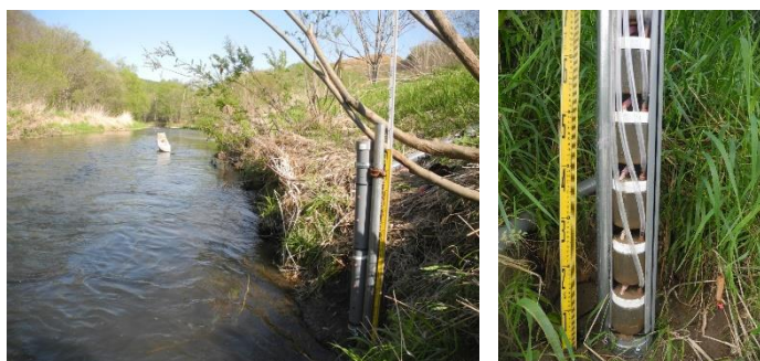
写真-1 ライジングステージサンプラーの設置状況 右の写真は、カバーを外した状態。 水位上昇に応じて採水口から河水が入ってくる仕組みになっている。
