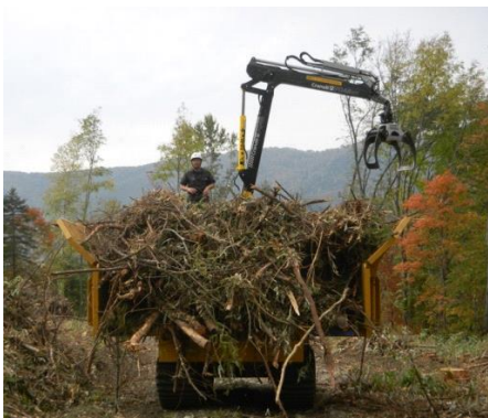
図-1 バイオマス収集対応型フォワーダ (MST800VDL、荷台が横に開閉し枝条を圧縮する)
