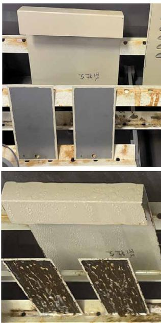
各種塗装鋼板の耐食性試験
