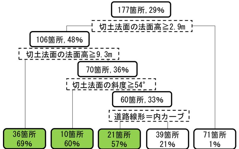
図-1 崩壊要因解析結果(切土法面)
