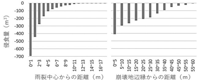
図-2 雨裂中心・崩壊地辺縁からの距離に応じた変化量(東和)
