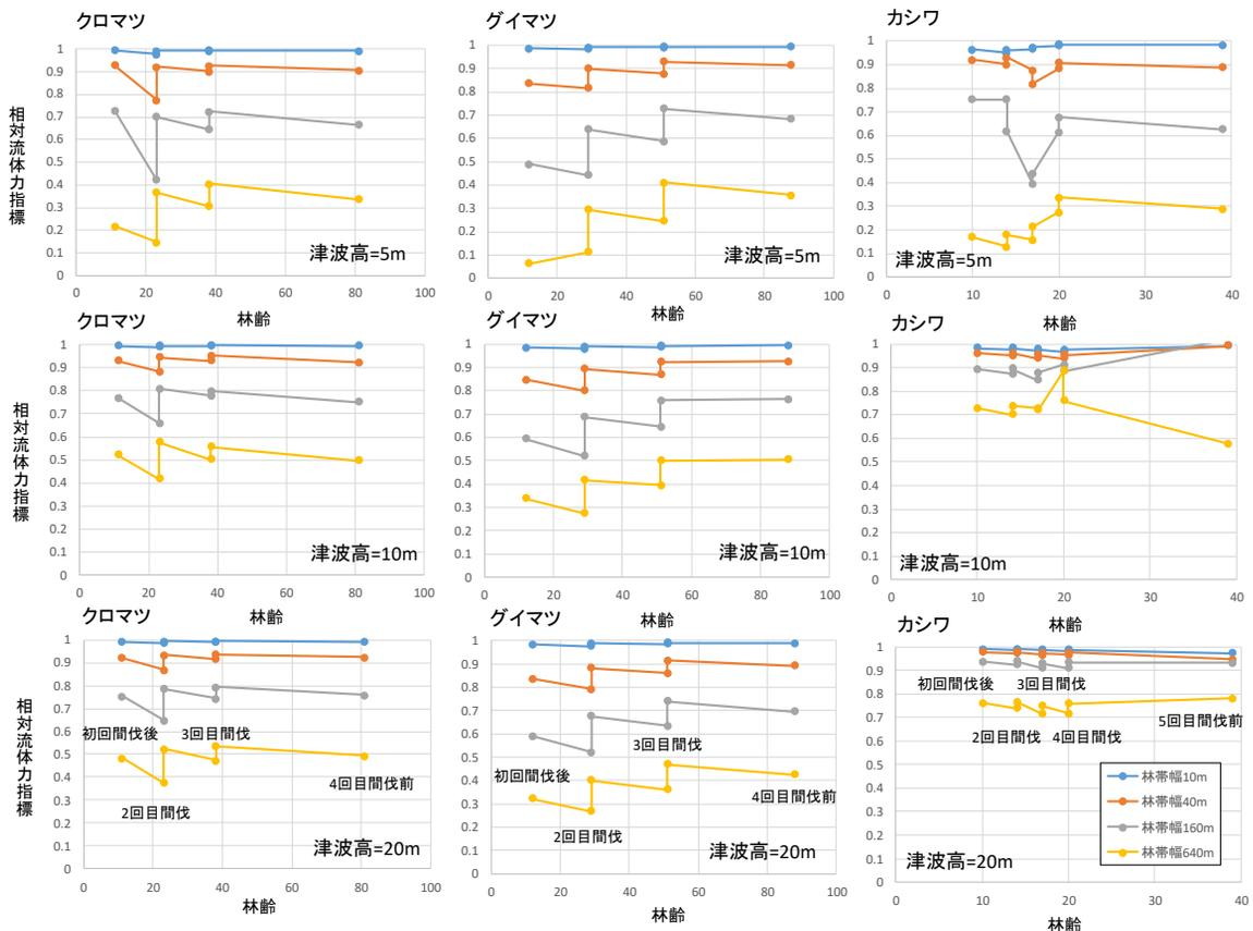
図-1 主要3種海岸防災林の施業体系に沿った津波減勢効果の時系列変化。相対流体力指標は林帯後方の流体力指標（水深×流速<sup>2</sup>で流れの勢いを示す）の林帯が無い場合を1とした相対値。
