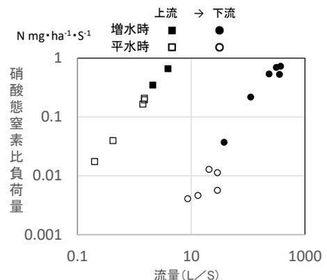
図-2 堆積岩トドマツ林流域における平水時と出水時の硝酸態窒素比負荷量の変化（流域面積：上流 7ha 下流 256ha）
