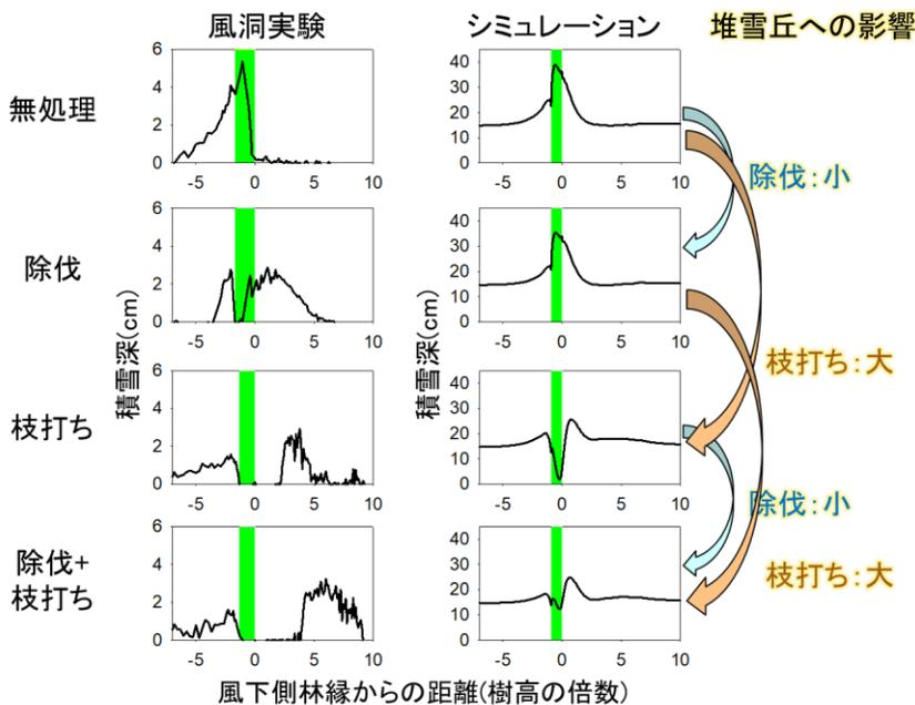
図-3. 風洞実験(枝打ち高: 樹高の21%、除伐率50%)と
