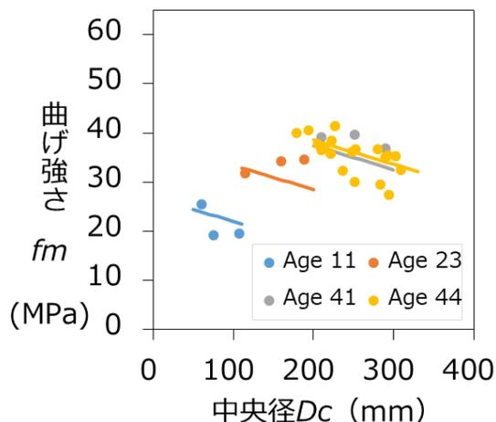
図-4 トドマツ丸太の曲げ強さ
