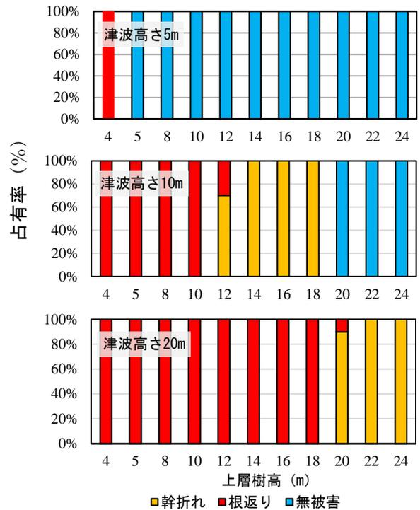
図-2. 林帯の成長と被害形態の変化（クロマツ無間伐，林帯幅100m）
