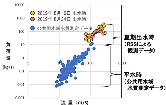
図-1 常呂川最下流地点（上川沿）における採水試料から得られたSS負荷量と流量の関係
