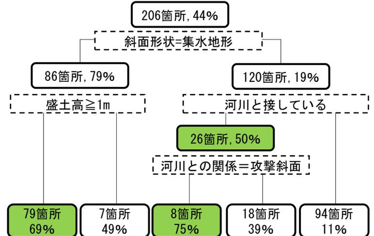
図-2 崩壊要因解析結果(盛土法面)
