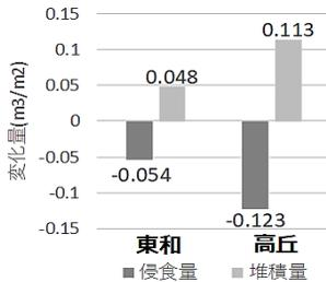
図-1 崩壊斜面表層の変化量
