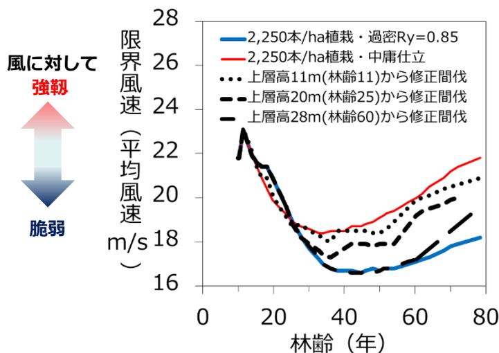
図-5 カラマツの過密林分に修正間伐をした場合の限界風速の推移
