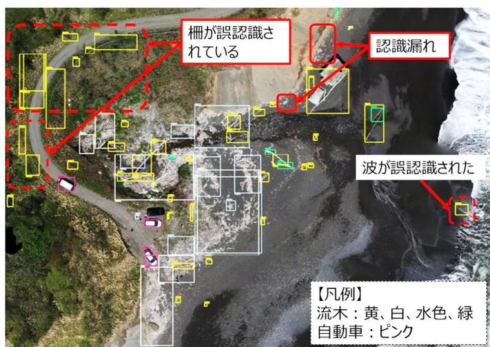
図-1 試作器による識別結果
