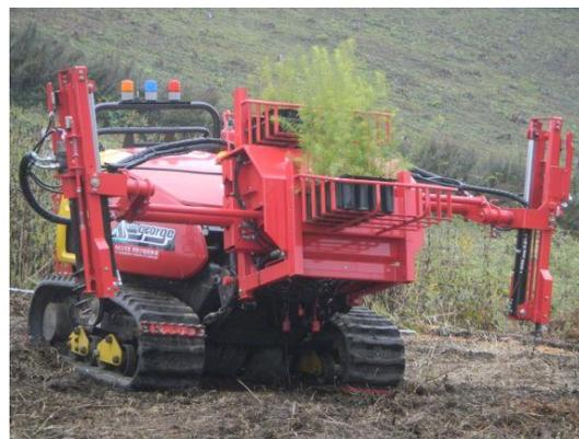
図-2 開発された土壤穿孔試験機
