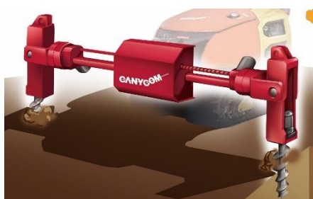
図-3 機体前方に設置された穿孔ユニット *当初は、傾斜など障害物に対応するために、穿孔作業前後にユニット全体を上下させていた。福岡での試験時ではユニット両端のオーガの動作と連動するようになった。
