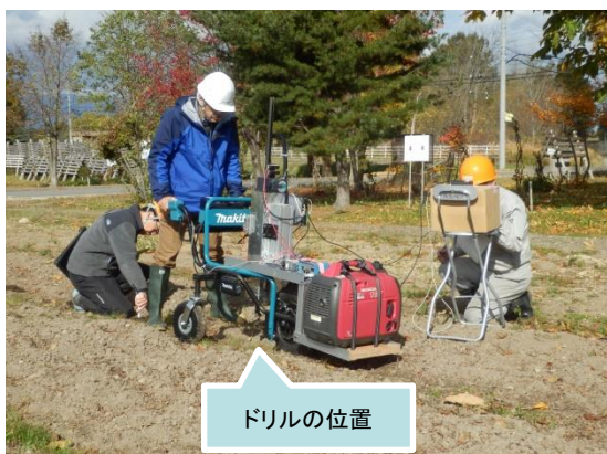
図-1 試作したオーガ試験機による土壤穿孔力測定の様子
